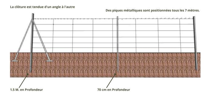
Les poteaux de tension jouent un rôle essentiel pour garantir la stabilité et la rigidité de la clôture. Conçus pour résister aux conditions les plus extrêmes, ils assurent à votre clôture une bonne tenue au fil du temps. Dans le but de nous adapter à vos besoins, nos clôtures vous sont proposées en différentes hauteurs et tailles de mailles.
